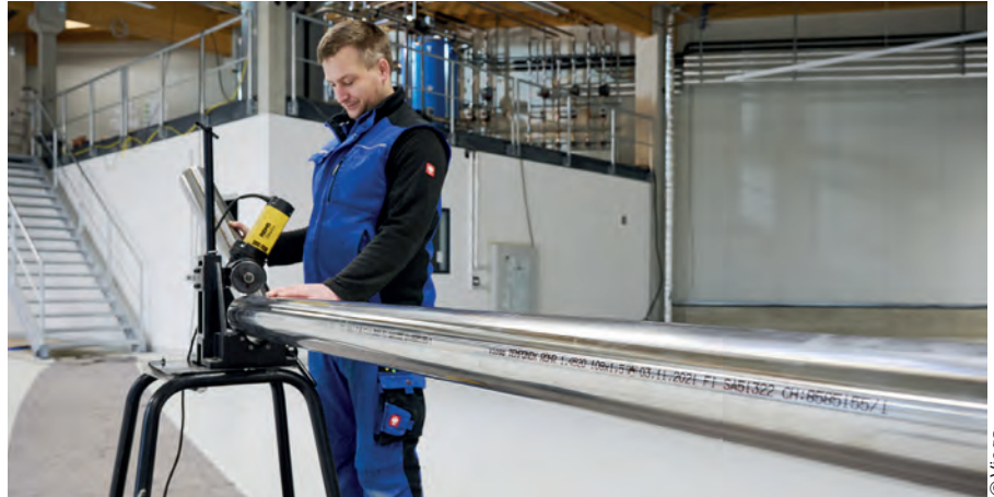
Das „Temponox“-Rohr ist verwechslungssicher mit einer braunen Linie gekennzeichnet. Hier Philipp Nünning beim Ablängen.
